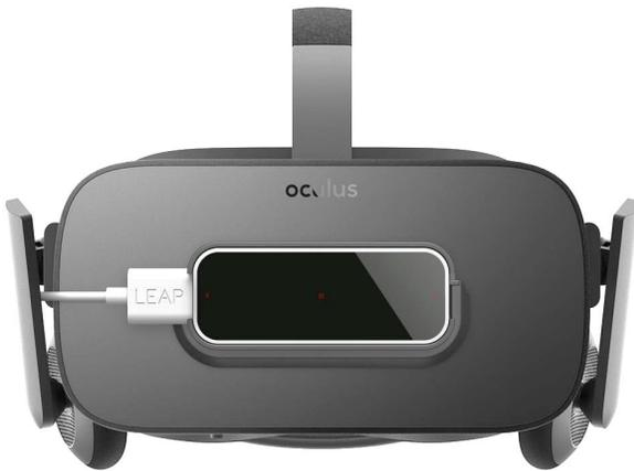
Positionierung des Leap-Sensors
