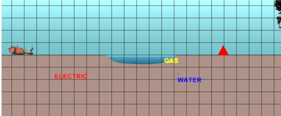
Anordnung bei einer Flussunterquerung (Hinweis: jeder Rasterabschnitt ist 10 x 10 Fuß)
