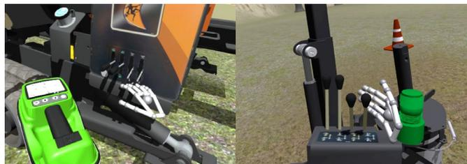
Bedienungselemente für Hilfsstützen, Neigung und Anker
